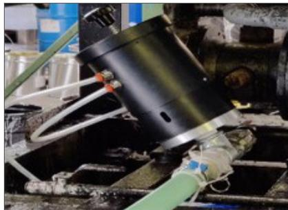
Der Trockenlaufschutz ist äußerst einfach und flexibel zu verwenden und ermöglicht somit den Einsatz in allen Bereichen der pneumatischen Flüssigkeitsförderung.
